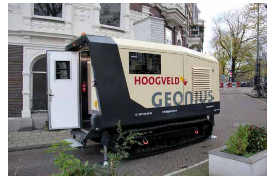
De boxed crawler is compact en heeft kunststof rupsbanden. Dat maakt hem zeer geschikt voor de smalle Amsterdamse straten.
