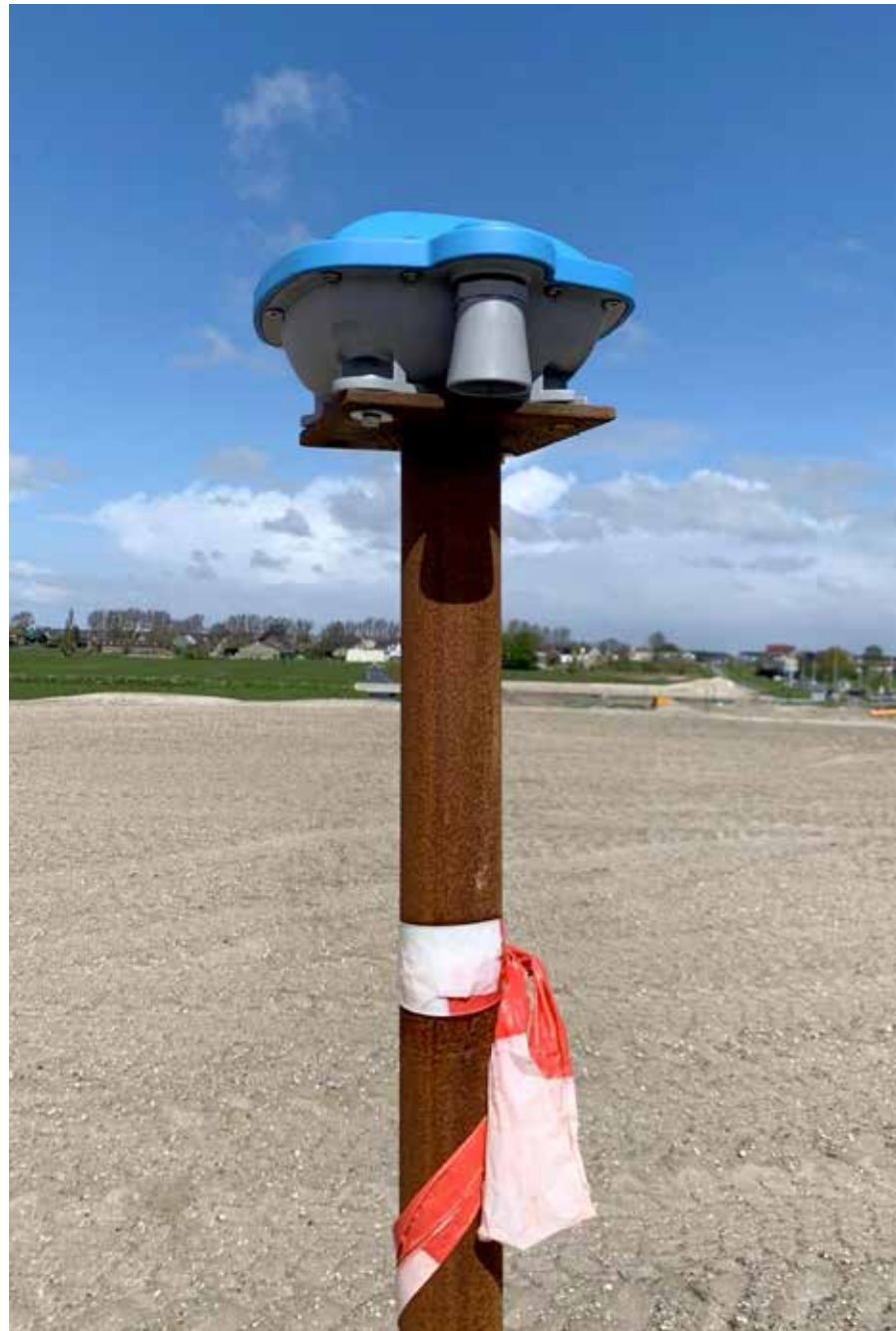
De IoT Geo PointR® wordt bevestigd aan de bovenkant van de zakbaak, verstuurt de data via een speciaal netwerk en wordt gevoed door een batterij.
